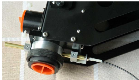
Abb. 5: Montierte Kalibrierlicht-Erweiterung am Lhires.
