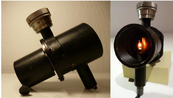
Abb. 3: Variable Spalteinheit mit eingeschalteter Neon-Kalibrationslampe.
