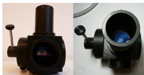
Abb. 2: des Gitterhalters von der Seite mit eingebautem Gitter (links) und Blick von oben auf die Kollimatorlinse (rechts).
