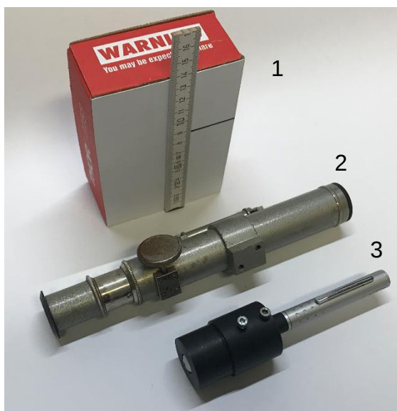
Abb. 3: Justier-Hilfsmittel: 1: Projektionsschirm mit Skala, 2: Messfernrohr, 3: Justierlaser
