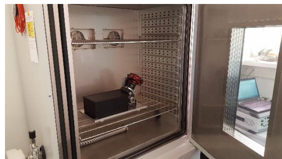
Abb. 12: Klimakammer (Bruker Nano GmbH).
